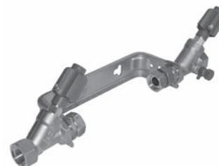
Gemäß DIN EN 14154-2:2011-06, DIN 1988 sowie des DVGW-Arbeitsblattes W 406 ist der Zählerplatz Ihrer Trinkwasseranlage so zu gestalten, dass keine mechanischen Spannungen auf den Zähler einwirken. Auch können ohne Zählerbügel gefährliche Berührungsspannungen auftreten. Das bedeutet Lebensgefahr – für Monteure und Hausbewohner.
