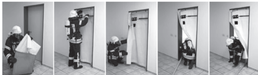
Funktionsweise des mobilen Rauchverschlusses
