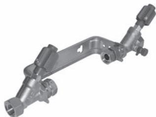
Gemäß DIN EN 14154-2:2011-06, DIN 1988 sowie des DVGW-Arbeitsblattes W 406 ist der Zählerplatz Ihrer Trinkwasseranlage so zu gestalten, dass keine mechanischen Spannungen auf den Zähler einwirken. Auch können ohne Zählerbügel gefährliche Berührungsspannungen auftreten. Das bedeutet Lebensgefahr – für Monteure und Hausbewohner.
